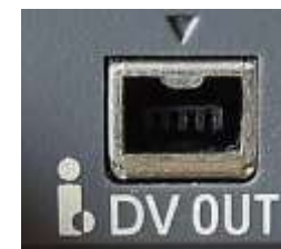
Gniazdo i-Link w kamerze cyfrowej firmy Sony
