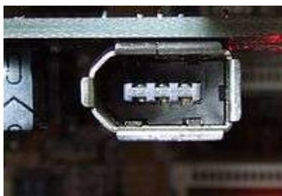
Gniazdo FireWire wewnątrz komputera
